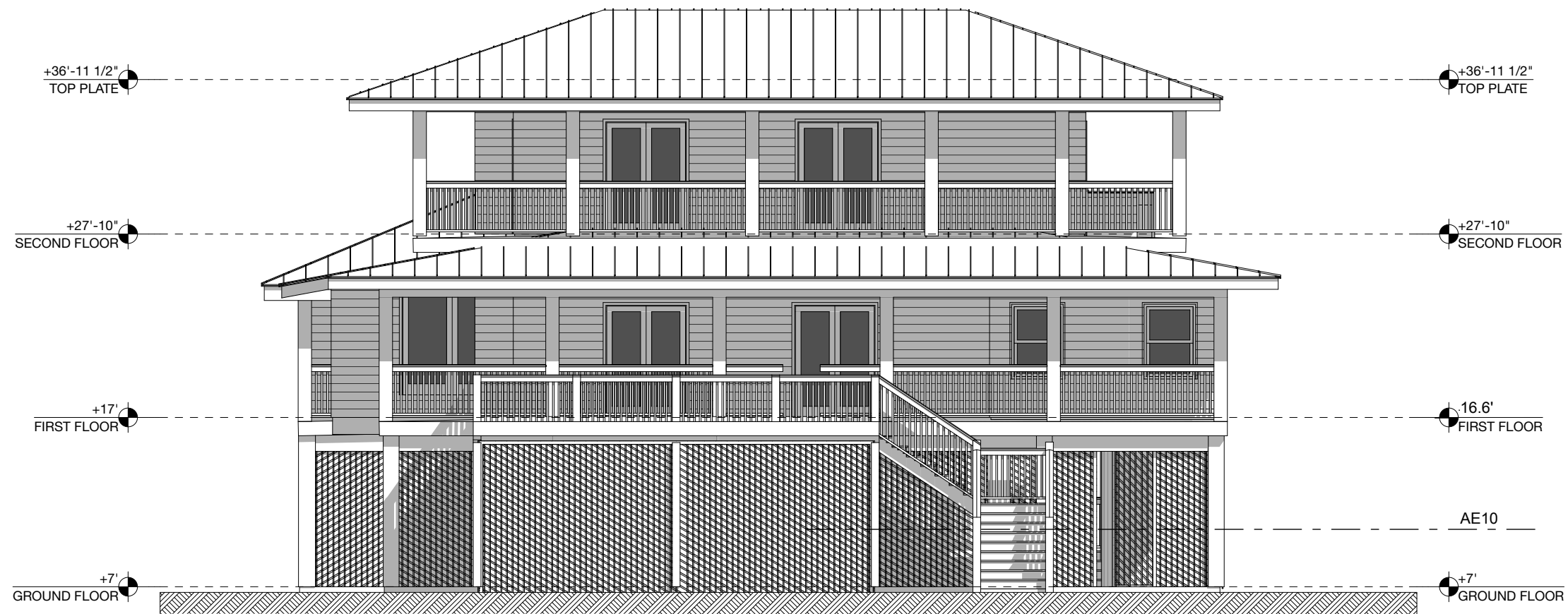
1 A3.4 LEFT ELEVATION EXISTING SCALE: 1/8" = 1'-0"
